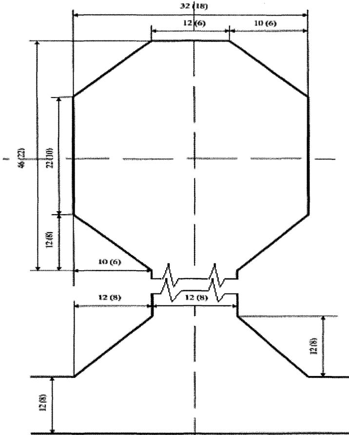
Рис. 2 Рекомендуемые размеры и конфигурация мест стоянки тяжелых и средних (легких) вертолетов (м)
