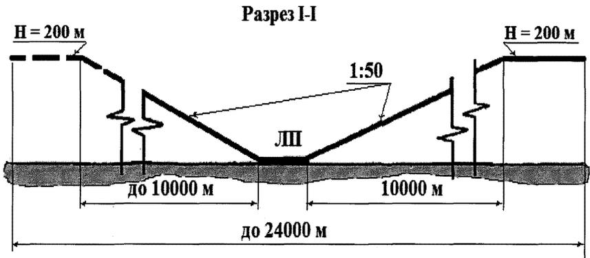
Рис. 7 Продольный профиль поверхностей ограничения препятствий для вертодрома с одной ВПП (вариант)
