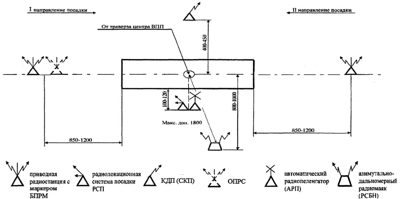
Рис. 13 Типовая схема размещения радиотехнических средств на вертодроме
