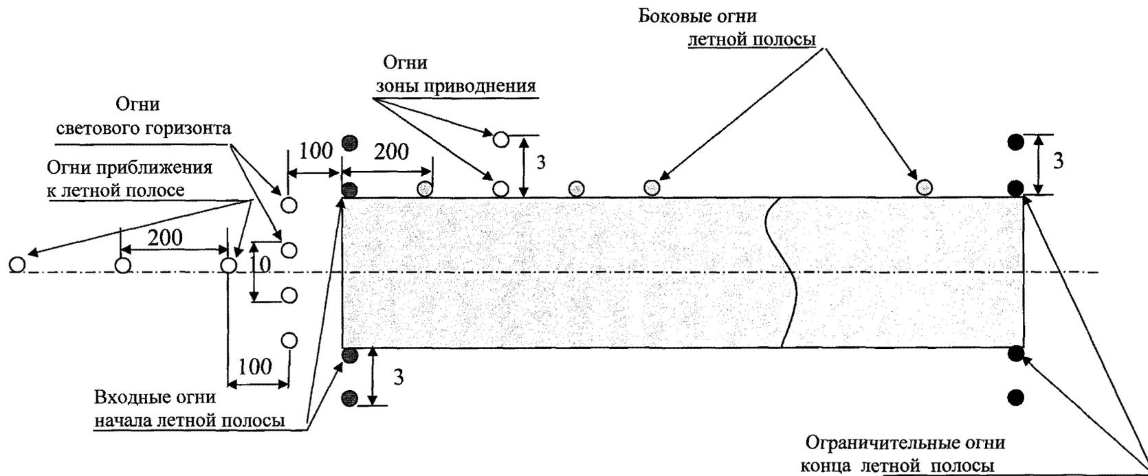
Рис.8 Типовая полная схема размещения светосигнального оборудования на гидроаэродроме.
