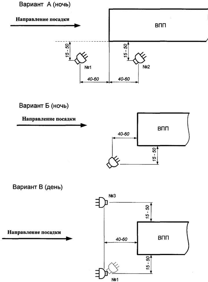
Рис. 16 Размещение прожекторных станций на вертодромах
