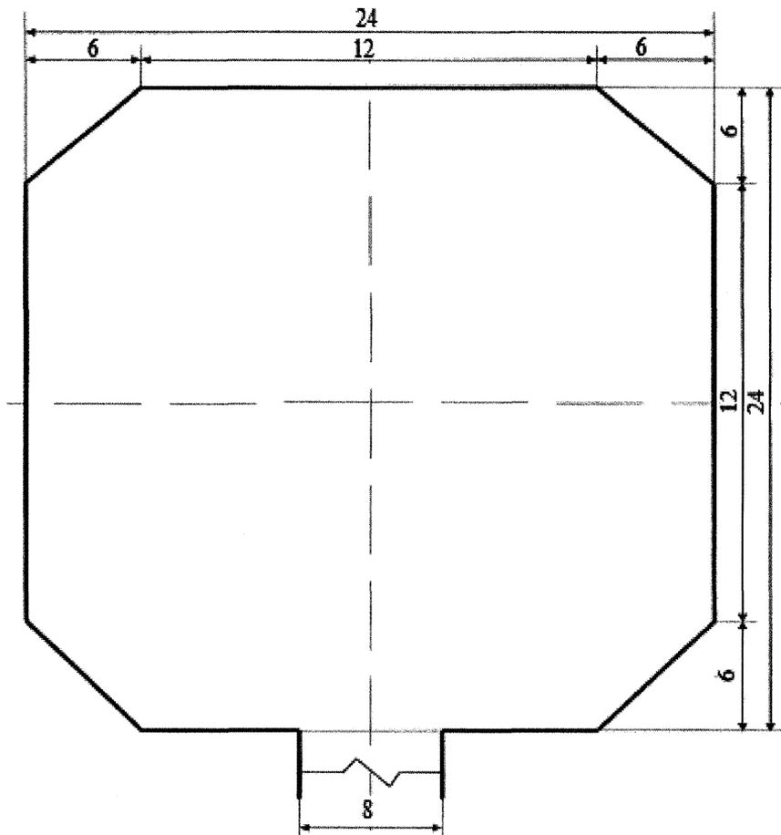
Рис.3 Рекомендуемые размеры и конфигурация мест опробования силовых установок и девиационных площадок легких вертолетов.
