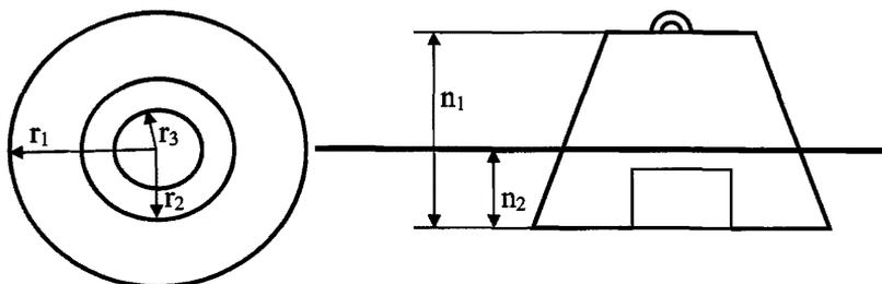
где:  $r_1$  – радиус основания мертвого якоря;  $r_2$  – радиус верхней части мертвого якоря;  $r_3$  – радиус выемки в днище мертвого якоря;  $n_1$  – высота мертвого якоря;  $n_2$  – заглубление основания мертвого якоря в грунте.
