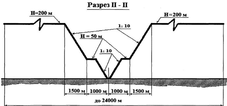
Рис. 8 Поперечный профиль поверхностей ограничения препятствий для вертодрома с одной ВПП
