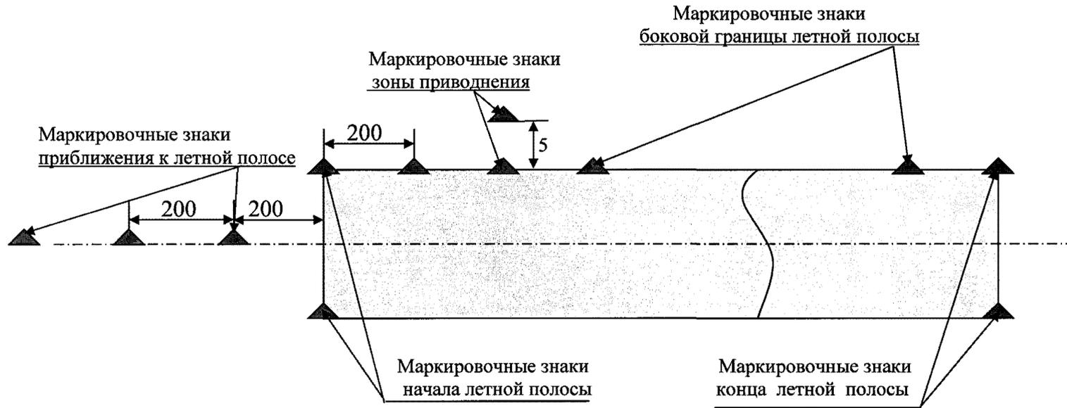
Рис.6 Типовая схема дневной маркировки летной полосы гидроаэродрома.
