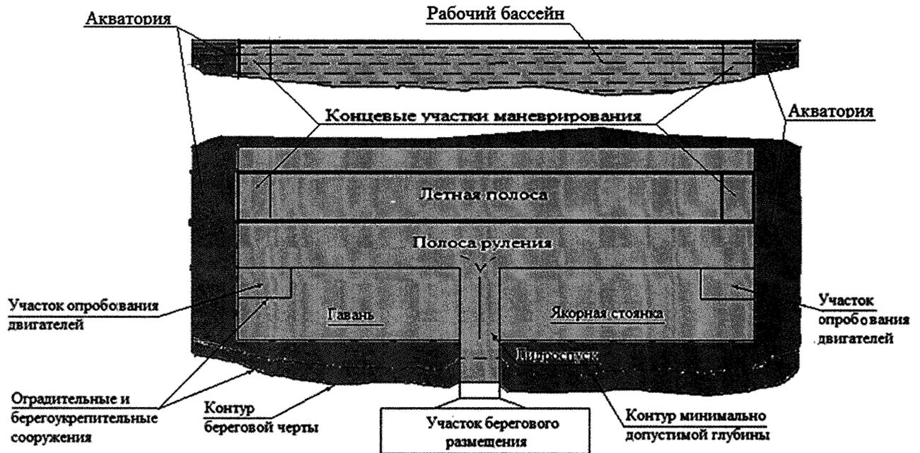
Рис.1 Типовая схема гидроаэродрома
