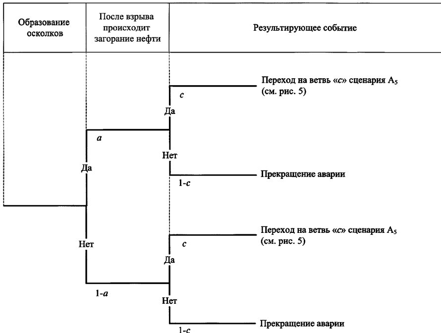
Рис. 6. Дерево событий при взрыве внутри подземного резервуара (типа ЖБР) (сценарий A_5 )
