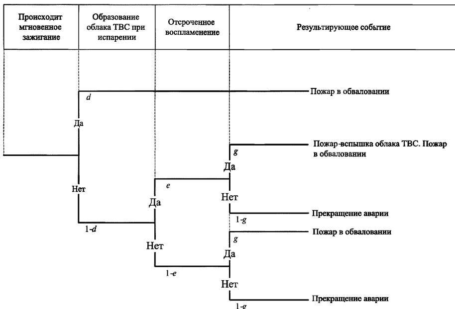
Рис. 4. Дерево событий разрушения/перелива подземного резервуара (сценарий A_4 )
