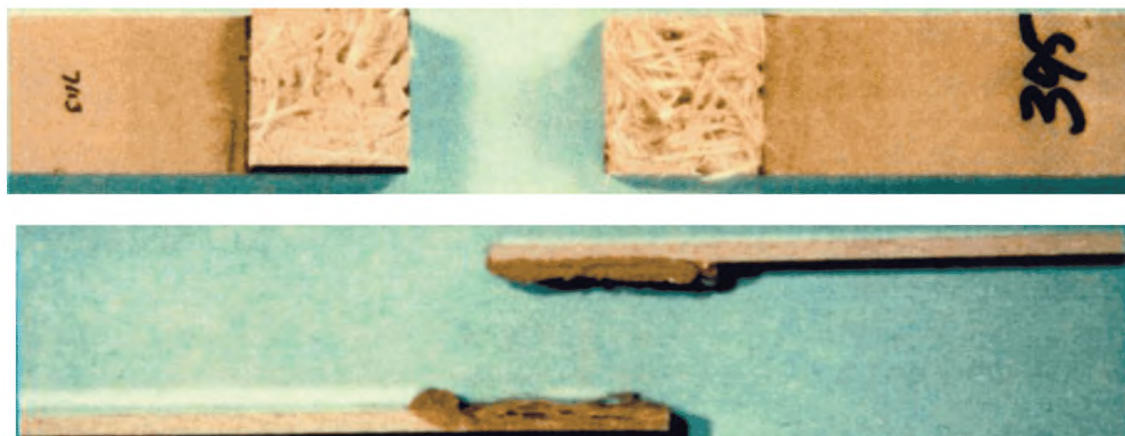
Рисунок А.13 — Разрушение из-за разрыва волокон
