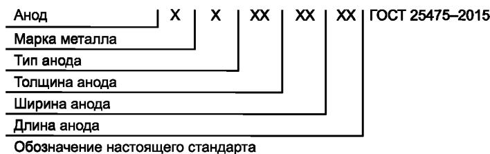
При этом используют следующие сокращения для обозначения типа анода: АН0 — анод без отверстий, АН1 — анод с одним отверстием, АН2 — анод с двумя отверстиями, АН4 — анод с четырьмя отверстиями.
