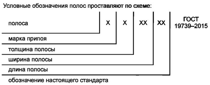
Пример условного обозначения полосы из серебряного припоя марки ПСр 45, толщиной 1,6 мм, шириной 100 мм, длиной 200 мм:
