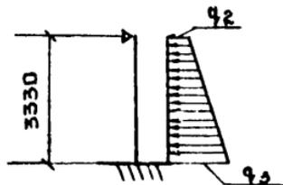
Продольных стен отстойников
