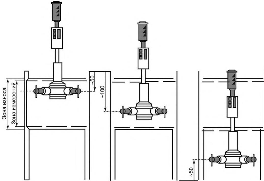
Рисунок А.1 — Три уровня высоты измерений диаметров
