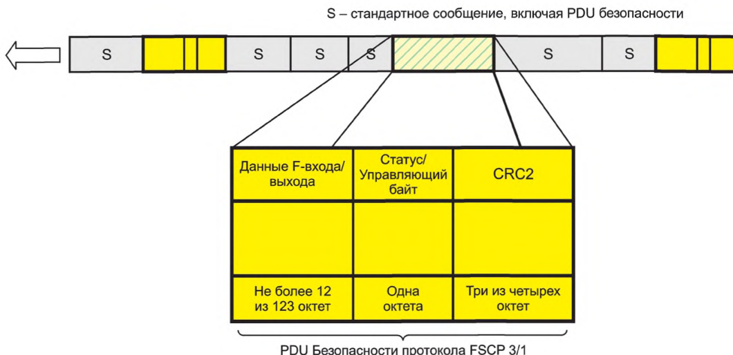
Рисунок 10 — Структура PDU безопасности профиля FSCP 3/1
