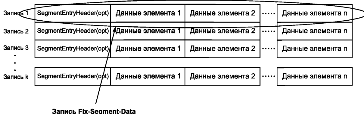
Рисунок С.4 — Запись (элемент массива в fixed-segment-data)
