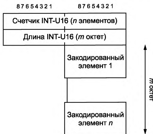
Рисунок F.6. — Кодирование типа SEQUENCE OF
