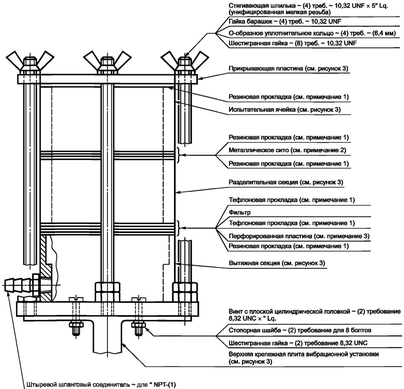
Примечание 1 – Внутренний диаметр – 2 3/4 дюйма (69,9 мм), наружный диаметр – 3 дюйма (76,2 мм), толщина 1/16 дюйма (1,6 мм).
