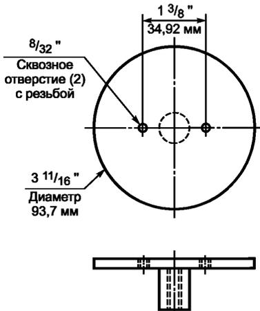
Верхняя крепежная плита вибрационной установки ~ Отверстия, как показано (например вибростенд компании Buffalo Dental MFG, модель № 1, или аналогичный)
