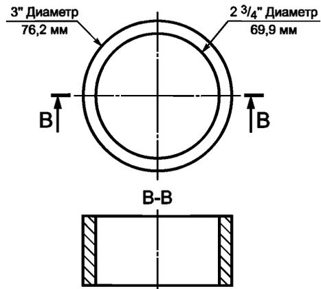
Прибородержатель и разделительная секция "BB" ~ (2) требование – алюминий
