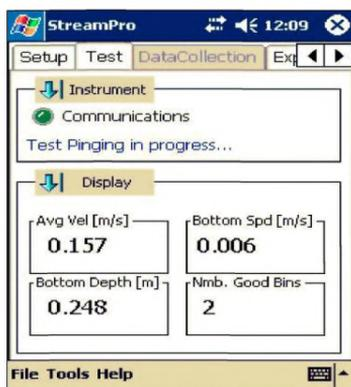
Рисунок 3 – Вид экрана КПК при запуске процедуры «Pinging» (тестовое «пингование»)
