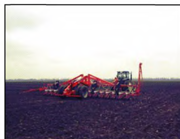
Сеялка пропашная KUNH Planter 3 TRS в агрегате с трактором «New Holland 7050» на посеве кукурузы
