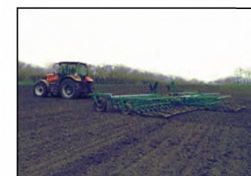
Трактор АТМ 3180М в агрегате со сцепкой СБГД-14 на предпосевном бороновании почвы
