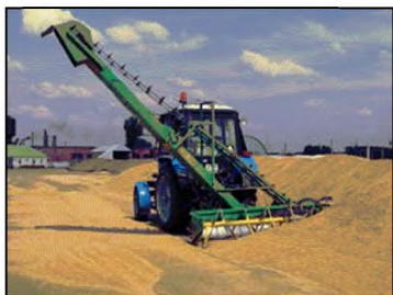
Погрузчик зерна навесной ПЗН-250 в работе
