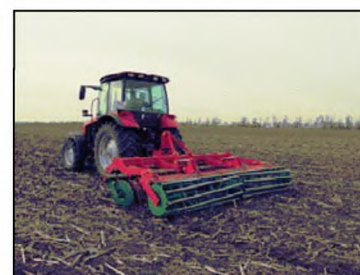
Дисковый лущильник UNIA ARES 4TXL в агрегате с трактором «Беларус 1523» на дисковом лущении стерни подсолнечника (второй след)
