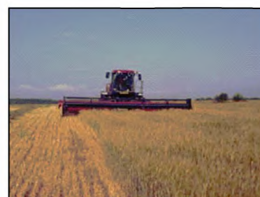
Косилка самоходная КС-200 в работе на скашивании зерновых культур
