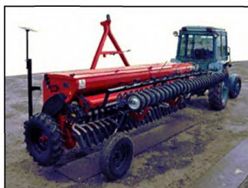
Сеялка СЗМ-400Т в транспортном положении в агрегате с трактором МТЗ-82
