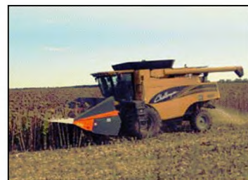
Приспособление OptiSun-870-PSM в агрегате с самоходным зерноуборочным комбайном «Challenger 660» на уборке подсолнечника
