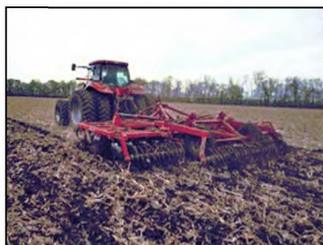
Борона дисковая модульная прицепная БДМП-6х4С-04 в работе
