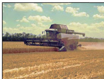
Комбайн зерноуборочный РСМ-152 "ACROS 590 Plus" на уборке озимой пшеницы
