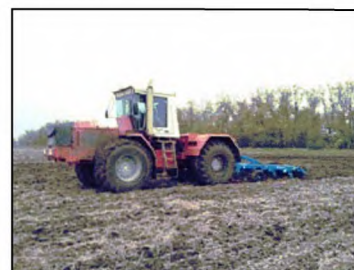
Плуг чизельный ПЧМ-4 в агрегате с колесным трактором К-744РЗ в работе, вид спереди слева
