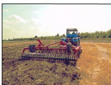
Борона дисковая модульная прицепная БДМП-4х4-04 в работе
