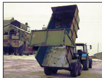
Полуприцеп в агрегате с трактором «Беларус 1221», кузов в поднятом положении
