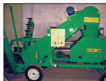
Погрузчик зерна электрический самоходный ПЗЭС-200 в транспортном положении
