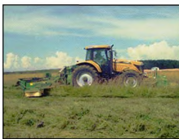
Косилка дисковая Easy Cut 9140CV Collekt + Easy Cut 32CV Float в агрегате с трактором Challenger MT 585 D в работе
