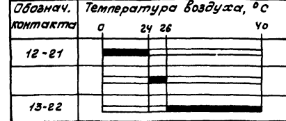
Диаграмма работы контактов датчиков температуры 1-SK1, 1-SK2
