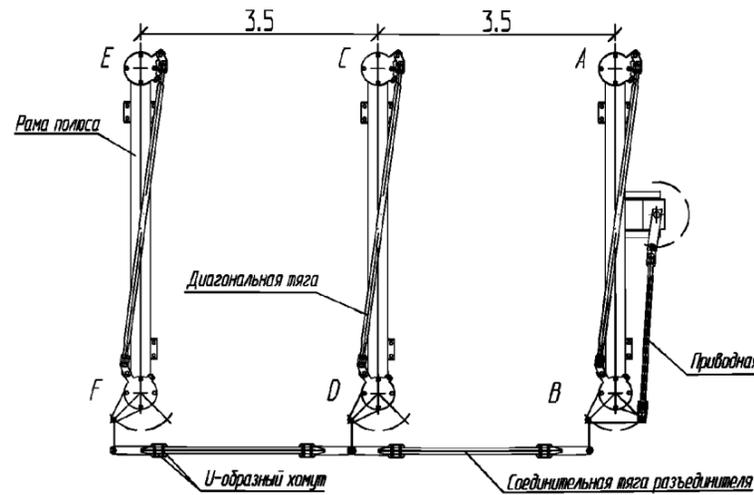
6. Монтаж приводной тяги заземлителя
