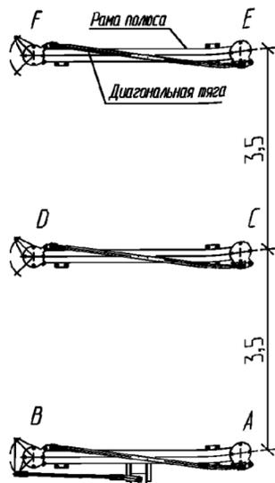
5. Установка соединительных тяг разъединителя
