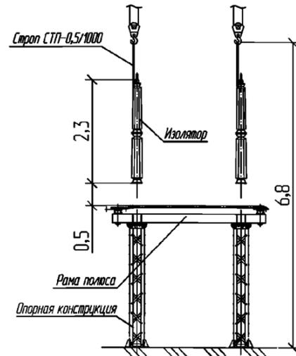
3. Монтаж привода разъединителя
