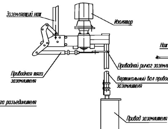
7. Общий вид смонтированного разъединителя
