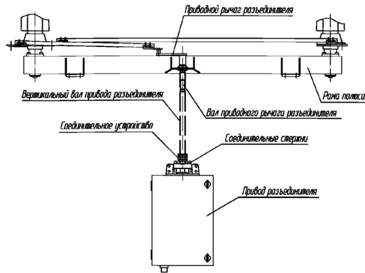
4. Установка приводной тяги разъединителя
