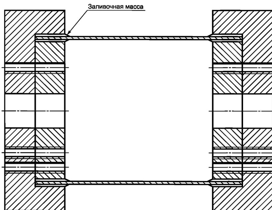
Рисунок 3 — Образец ПКМ, закрепленный в приспособлении для сжатия
