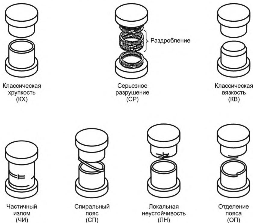
Рисунок 4 — Виды разрушения образцов кольцевой намотки при сжатии
