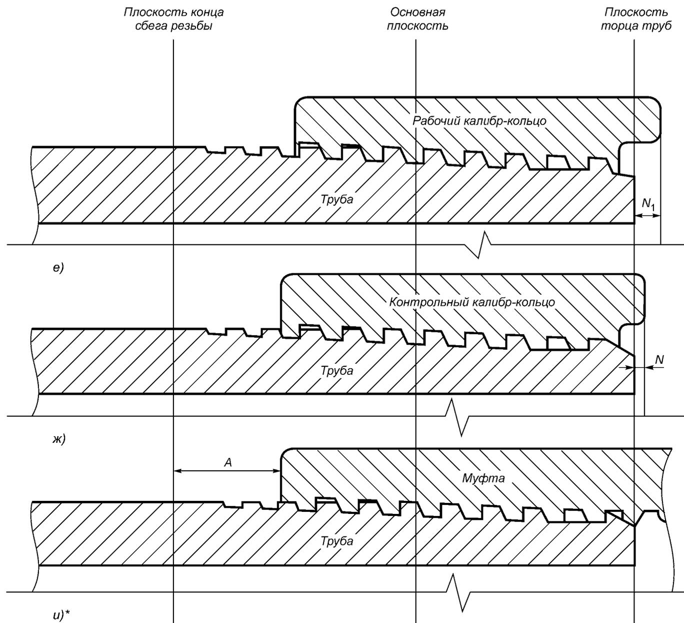
\* Соединение трубы и муфты с номинальными геометрическими параметрами резьбы, свинченное вручную.
