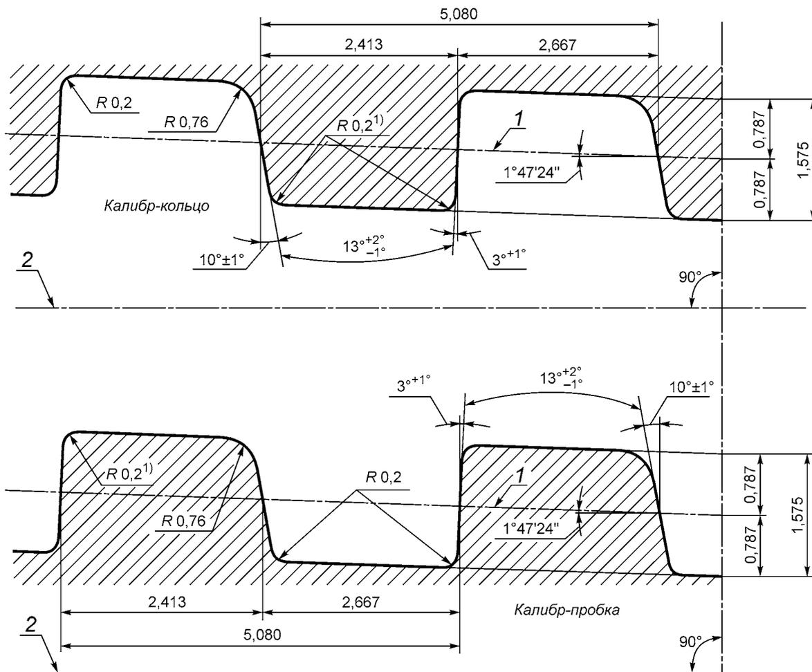
1) Допускается выполнение фаски с углом  $60^\circ \pm 1^\circ$  и шириной  $(0,20 + 0,05)$  мм.
