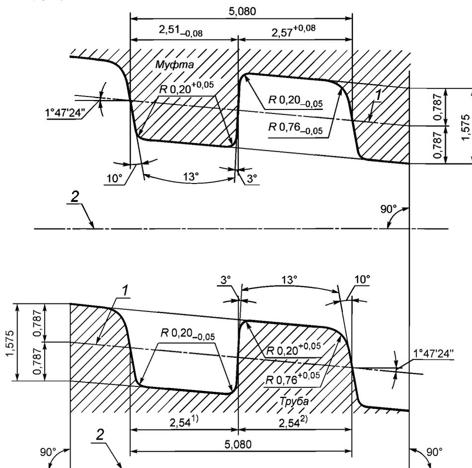
1) Предельные отклонения ширины впадины для резьбы номинальным диаметром 193,68 мм и менее — плюс 0,08 мм; для резьбы номинальным диаметром 219,08 мм и более — плюс 0,13 мм.
