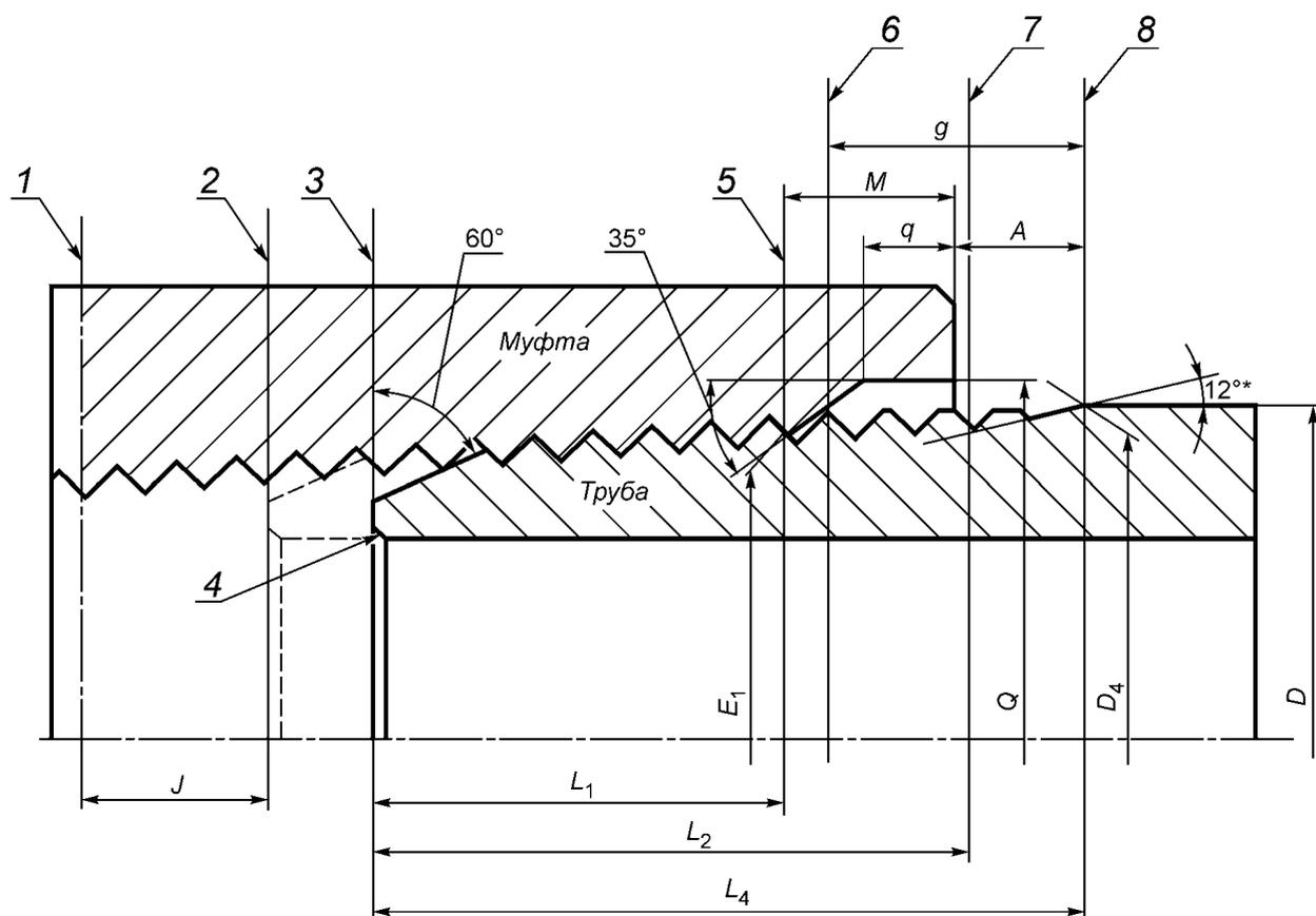
1 — плоскость середины муфты; 2 — торец трубы при механическом свинчивании; 3 — торец трубы при ручном свинчивании; 4 — притупление внутренней кромки торца трубы; 5 — плоскость ручного свинчивания; 6 — основная плоскость; 7 — плоскость начала сбега резьбы; 8 — плоскость конца сбега резьбы
