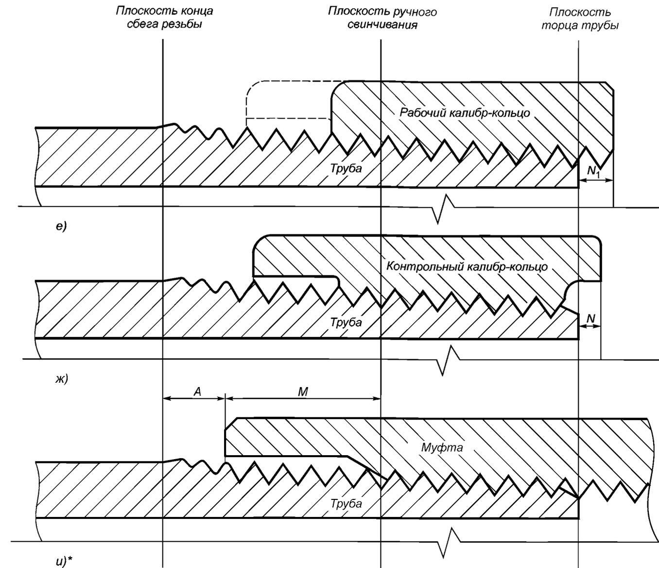
\* Соединение трубы и муфты с номинальными геометрическими параметрами резьбы, свинченное вручную.
