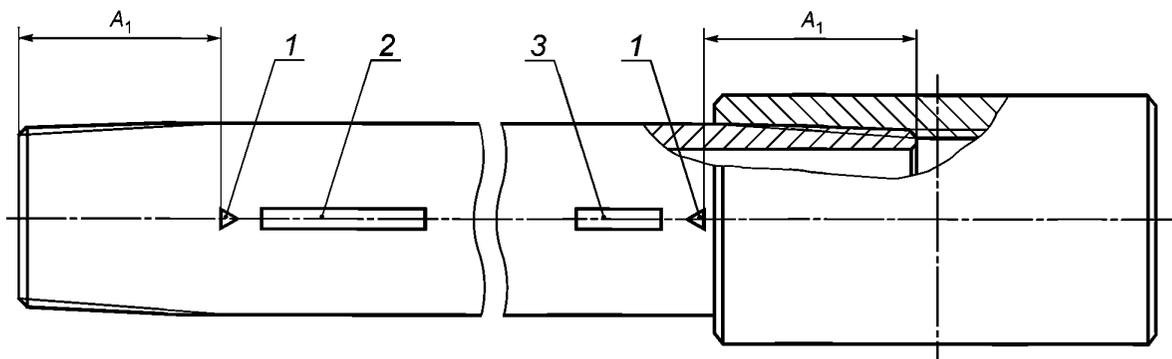
1 — треугольное клеймо; 2 — полоса размером 25 × 610 мм на nippleном конце трубы; 3 — полоса размером 25 × 102 мм на муфтовом конце трубы;  $A_1$  — расстояние от торца трубы до основания треугольного клейма
