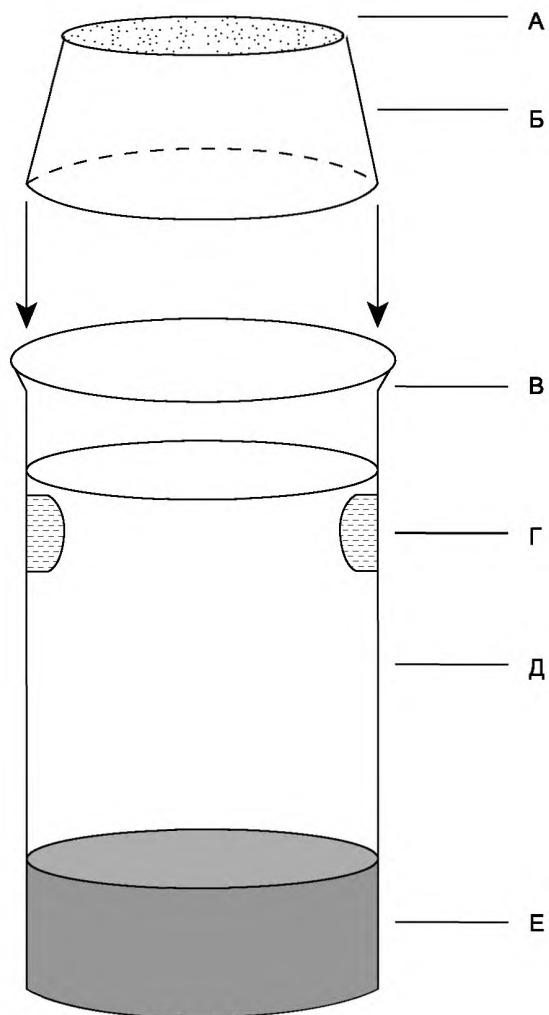
А — нейлоновая сетка; Б — перевернутая пластиковая чашка; В — безлопастной стакан для воздействия;
