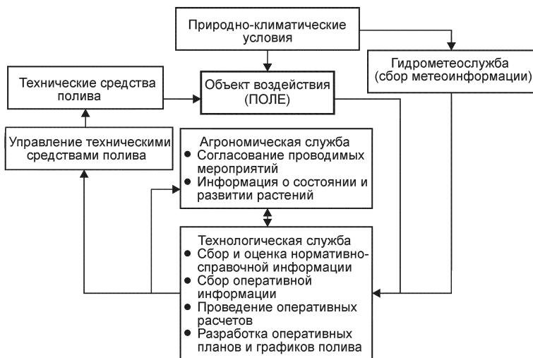
Рис. 15. Структурно-функциональная схема оперативного управления поливами
