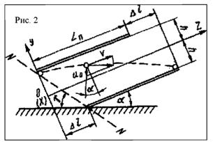
На рис. 2 показана схема осаждения частицы В тонкослойном элементе, из которой видно, что В каждый момент времени действительная величина и направление скорости движения частицы взвеси отстойнике В
