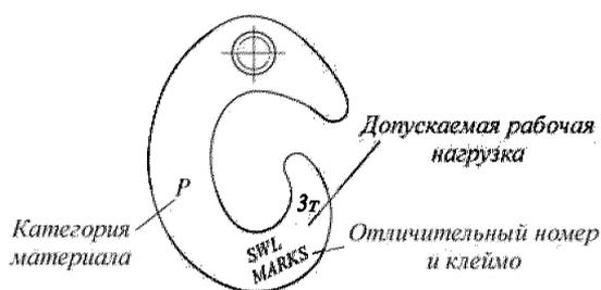
Рис. 11.2.1-1 Маркировка гака
