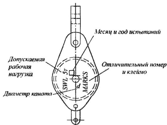
Рис. 11.2.1-5 Маркировка блока
