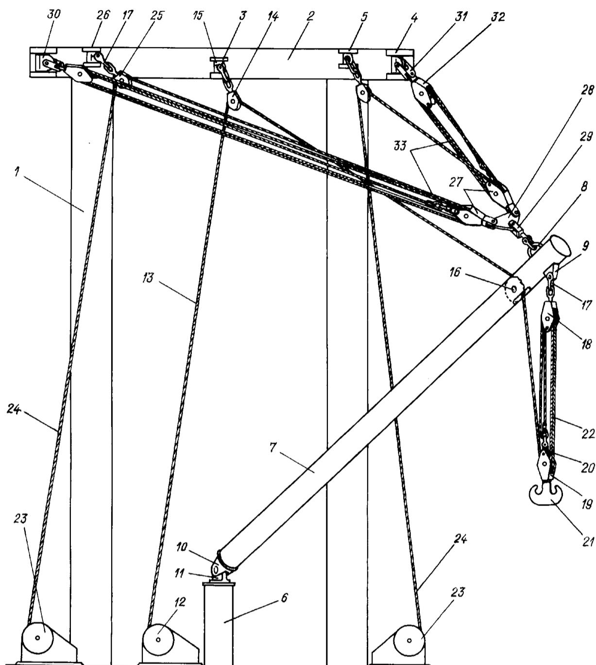
Рис. 3 Типовая оснастка тяжелой двухтопенантной механизированной стрелы:
