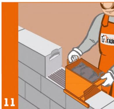
Приготовленный клей при помощи зубчатой каретки или кельмы для клеевого раствора (см. инструменты), подбираемых в зависимости от ширины блоков, наносится на поверхность 2-3 блоков, не оставляя свободных зон.
