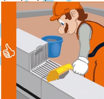
**Кельма** для клеевого раствора - это эффективный инструмент для нанесения клея на вертикальные и горизонтальные поверхности блоков, для ведения кладки и строительства стен сложной конфигурации. Выпускаются шириной 100, 200, 300 и 400 мм.
