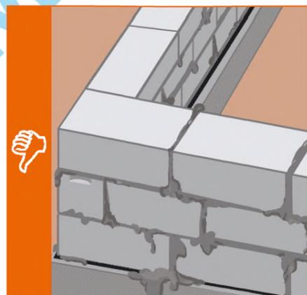
Использование для нанесения клея мастерка, шпателя и других подручных средств ведет к формированию неравномерного шва, перерасходу клея и снижению однородности кладки.
