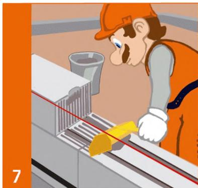
На торцевые стороны блока (тычок) наносить клей с помощью кельмы (см. инструменты), равномерно распределяя его по всей плоскости.
