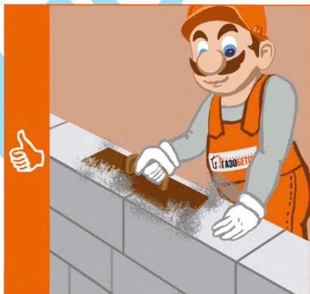
**Рубанок** для газобетона применяется для грубой шлифовки, стачивания гребней, укорачивания и подгонки газобетонных блоков.
