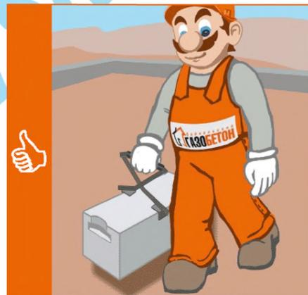
**Захват** для газобетонных блоков предназначен для быстрого и удобного перемещения газобетонных блоков.
