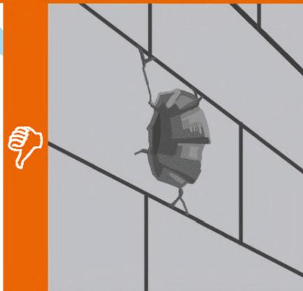
Пробивка технических отверстий при помощи ручных инструментов (молотка и зубила) приводит к появлению трещин в блоке, формированию рваных границ отверстия, что затрудняет прокладку коммуникаций и требует дополнительной герметизации краев отверстия.
