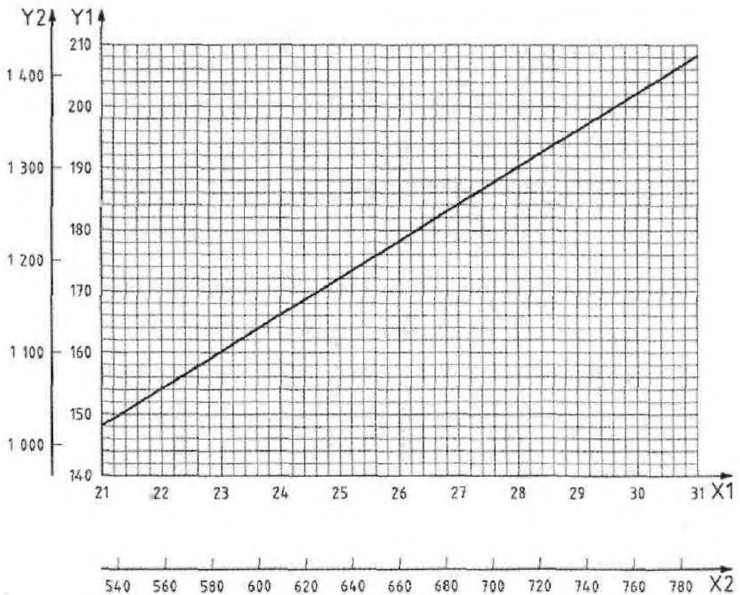
X1 барометрическое давление, дюймы рт.ст.; X2 барометрическое давление, мм рт. ст.;
