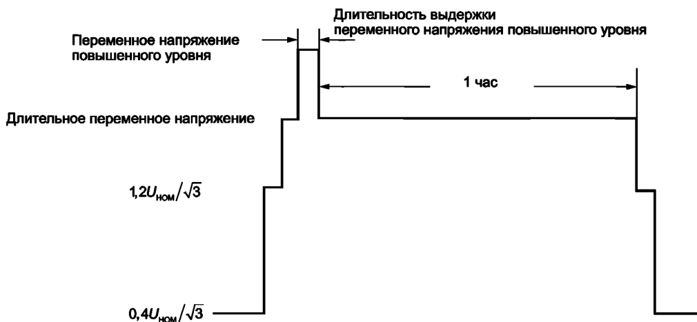
Рисунок 1 — Временная последовательность приложения испытательного напряжения при испытании длительным переменным напряжением с измерением интенсивности частичных разрядов (ДПН)
