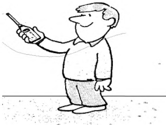
Рисунок 2 — Пример перемещения шумомера во время измерений
