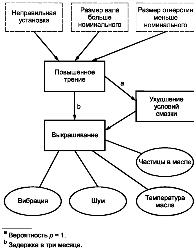
Рисунок F.1 — Дерево причинно-следственных связей для процесса выкрашивания подшипника качения
