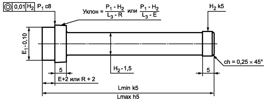
$$L_{min} = L_3 \\ L_{max} = L_{min} + \text{зеркальный зазор}$$
