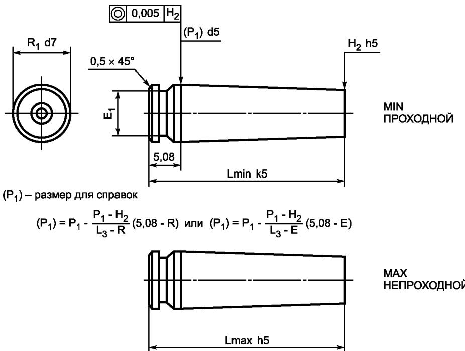
$$\begin{aligned} L_{\min} &= L_3 \\ L_{\max} &= L_{\min} + \text{зеркальный зазор} \end{aligned}$$
