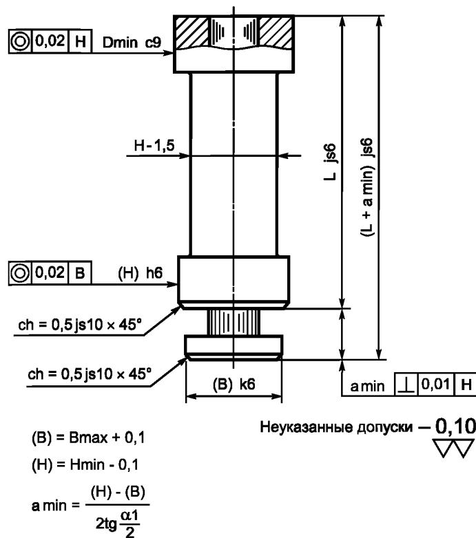
П р и м е ч а н и е : 1. Задняя поверхность скользящего стержня не должна выступать относительно поверхности наружной детали калибра.
