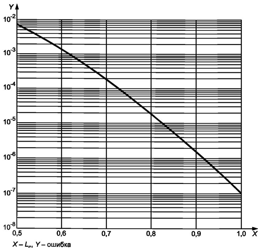
Рисунок А.2 — Ошибка ограниченного интервала в зависимости от константы среза  $L_c$ Т а б л и ц а А.1 — Ошибка ограниченности интервала при разных значениях константы среза  $L_c$
