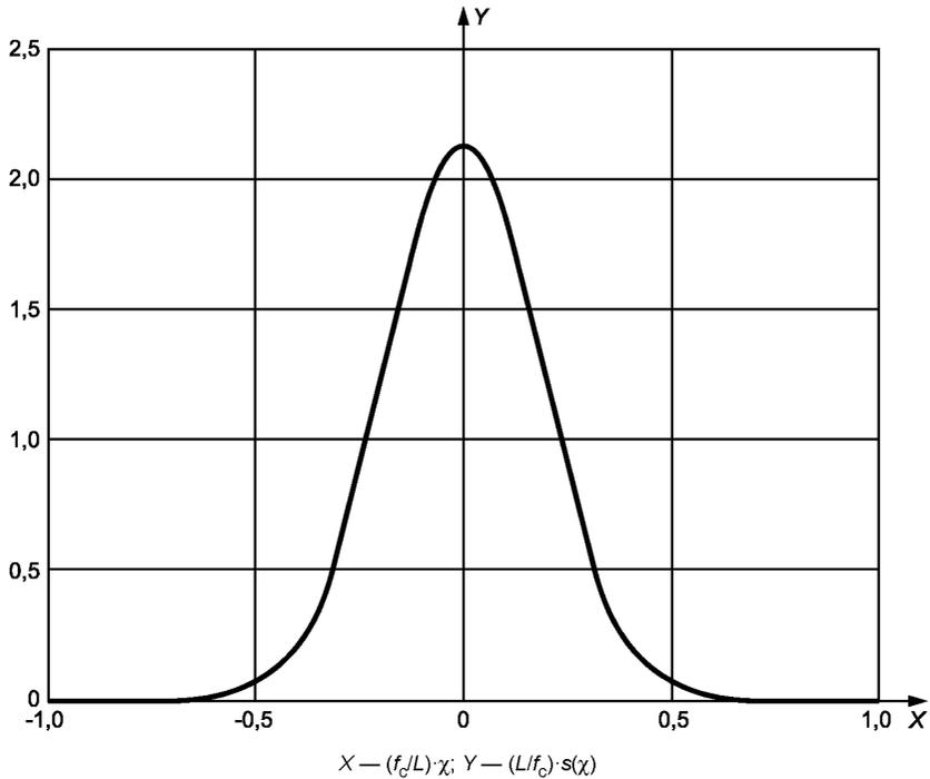
Рисунок 6 — Весовая функция Гауссова фильтра замкнутого профиля
