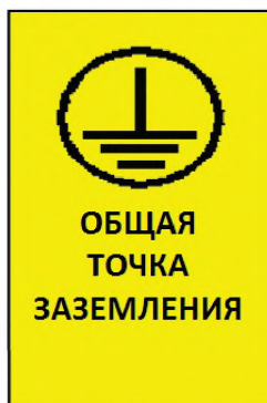
Рисунок 4 — Пример этикетки общей точки заземления для МКСМ типа С
