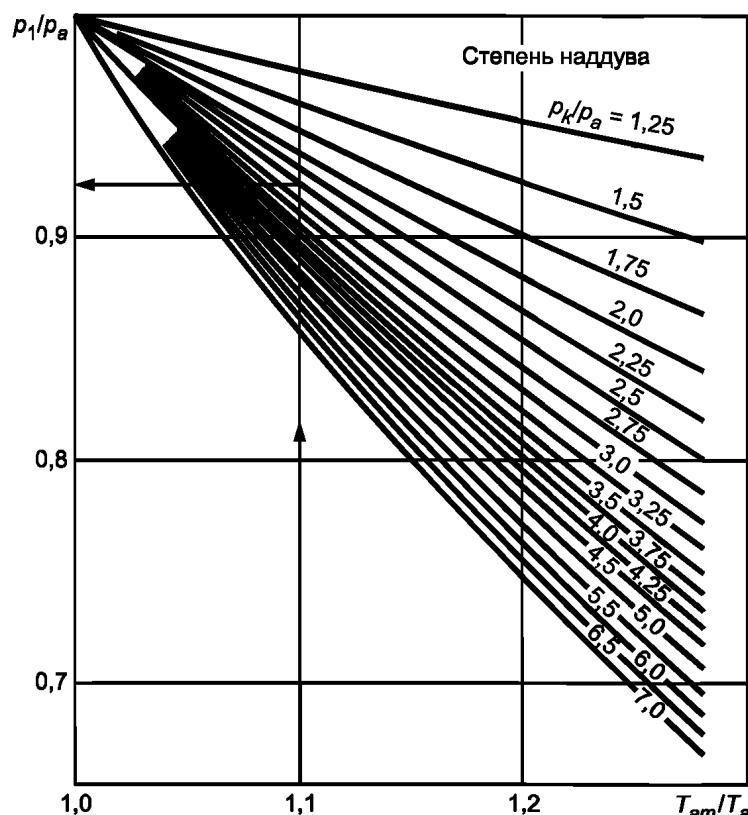
$p_a$  — давление окружающей среды при испытаниях;  $p_1$  — давление воздуха после дросселя;  $\rho_K$  — давление воздуха на выходе из компрессора;  $T_a$  — температура окружающей среды при испытании;  $T_{am}$  — температура окружающей среды на месте установки двигателя
