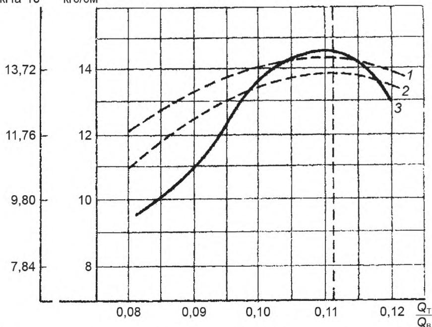
1 – начальная детонационная характеристика эталонного топлива; 2 – детонационная характеристика эталонного топлива, снятая в день испытания; 3 – детонационная характеристика испытуемого топлива
