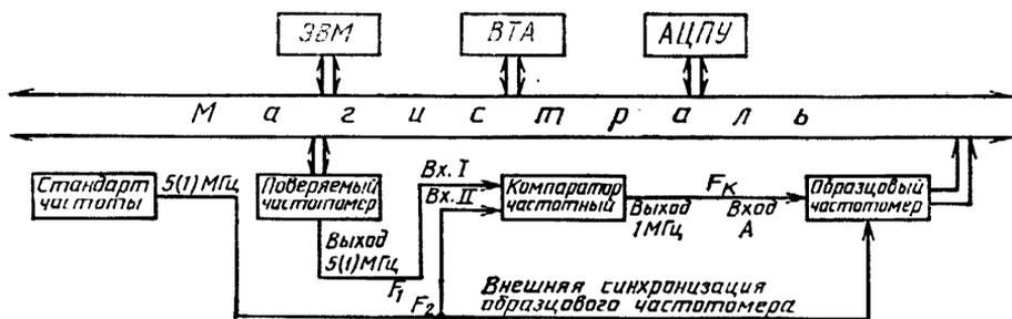
Рис. 2. Функциональная схема включения средств проверки при определении основной относительной погрешности частоты кварцевого генератора.
