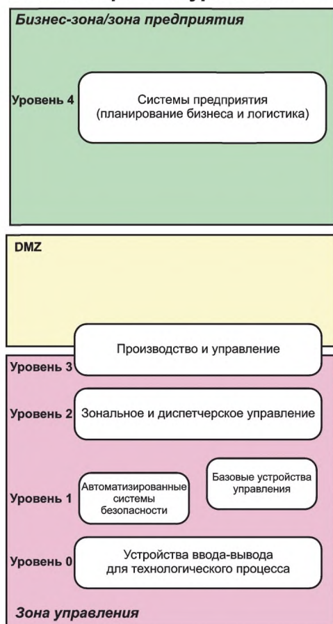
Рисунок А.8 — Соответствие между базовой архитектурой и примером сегментированной архитектуры
