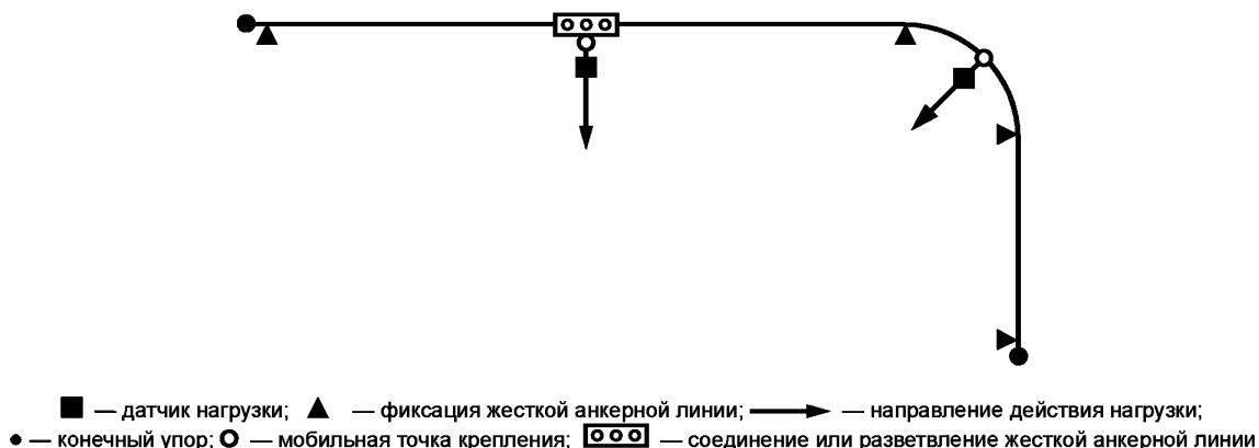
Рисунок 18 — Пример организации испытаний для анкерного устройства типа D, содержащего соединение или разветвление жесткой анкерной линии или угловой анкер
