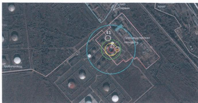
**Рис. 5-4.** Зоны распространения ударной волны при взрыве ТВС
