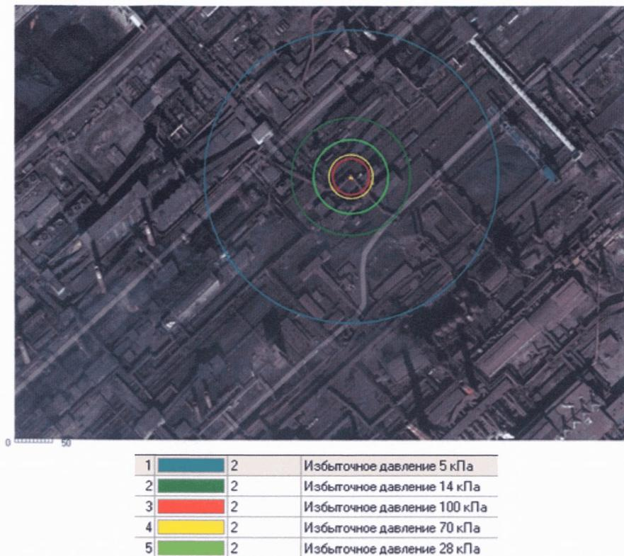
Рис. 5-2. Зоны распространения ударной волны при взрыве ТВС
