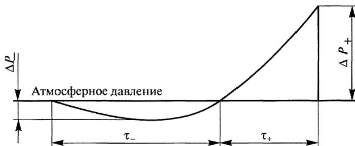
Рис.1. Характерный профиль ударной волны
