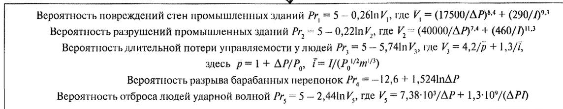
Рис. 3-1. Алгоритм расчета последствий аварийных взрывов топливно-воздушных смесей
