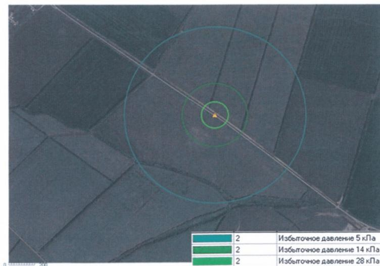
Рис. 5-1. Зоны распространения ударной волны при взрыве ТВС
