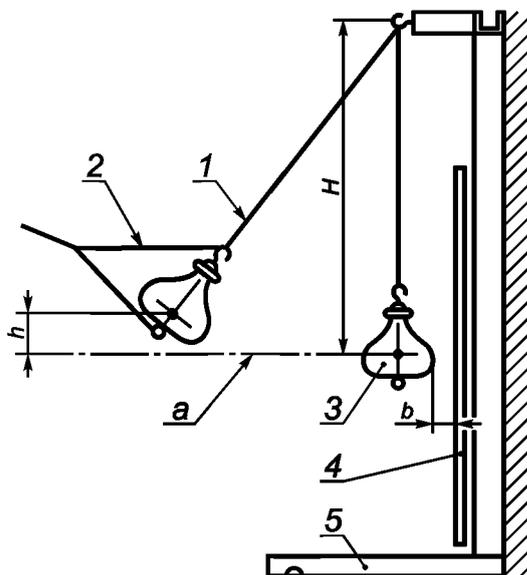
1 — стальной трос диаметром 2,5—4 мм; 2 — уздечка для подъема мешка; 3 — кожаный мешок (мягкое тело); 4 — испытуемый образец; 5 — опора;
