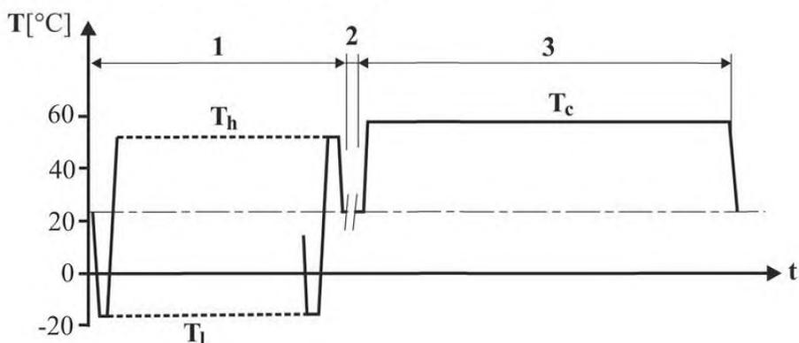
1 – первый этап испытаний; 2 – второй этап испытаний; 3 – третий этап испытаний;  $T_h$  – температура выдержки, равная  $(53,0 \pm 2,0)$  °С;  $T_c$  – температура выдержки, равная  $(58,0 \pm 2,0)$  °С,  $T_l$  – температура выдержки, равная минус  $(18,0 \pm 2,0)$  °С
