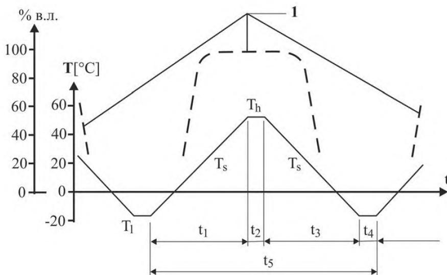
1 – относительная влажность в течение температурного цикла;  $T_h$  – температура выдержки, равная  $(53,0 \pm 2,0) ^\circ\text{C}$ ,  $T_i$  – температура выдержки, равная минус  $(18,0 \pm 2,0) ^\circ\text{C}$ ;  $T_s$  – перепад температур, равный  $(14 \pm 2,0) ^\circ\text{C}$  в течение часа;  $t$  – интервалы времени
