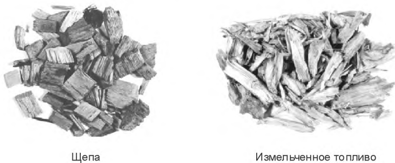
Рисунок А.2 — Различие между щепой и измельченным топливом
