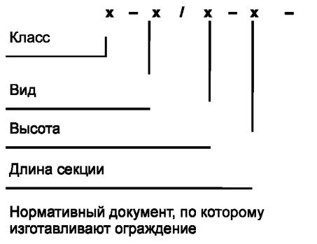
*Пример обозначения основной части маркировки пешеходного и защитного ограждения: УПО-Д обозначает, что ограждение удерживающее пешеходное (УПО), дорожное (Д).*
