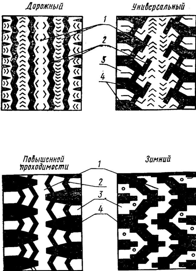
1 — продольные ребра; 2 — узкие канавки; 3 — грунтзацепы;
