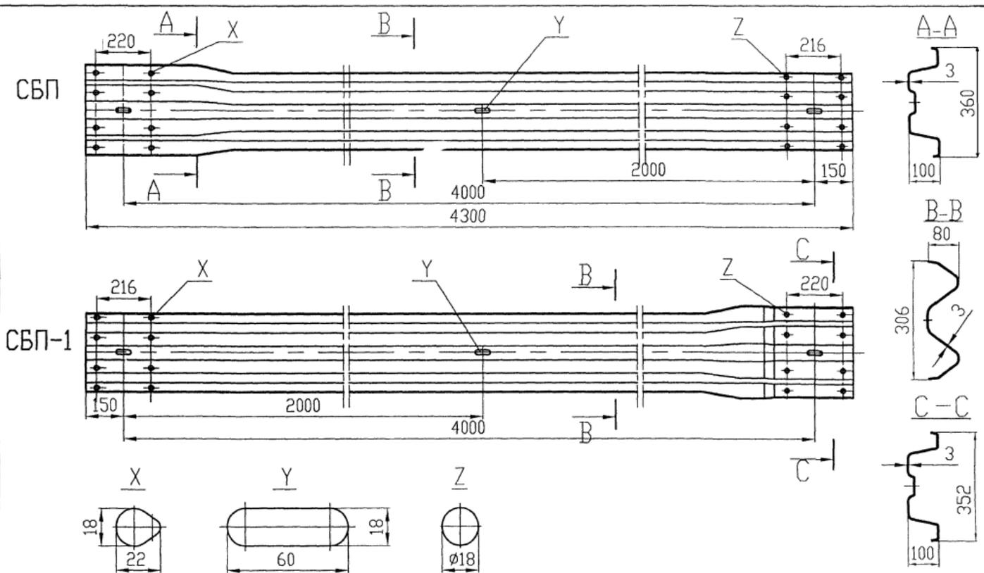
черт.46 Секция балки переходная /СБП/16.00/
