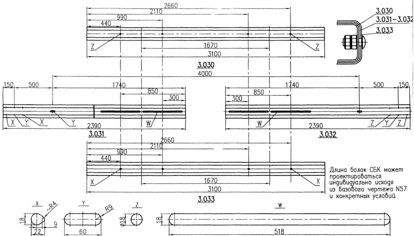
черт.57 Секция балки корытная над деформационным швом.
