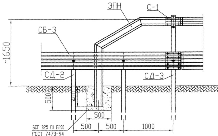
Установка элемента понижающего конечного/520 кДж
