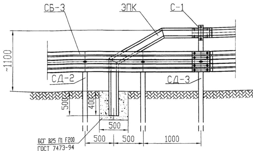
Установка элемента понижающего конечного/400 кДж
