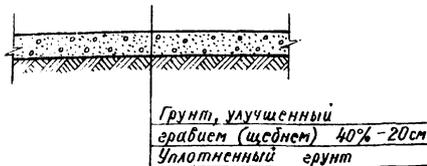
Поперечный разрез обвалования резервуарного парка
