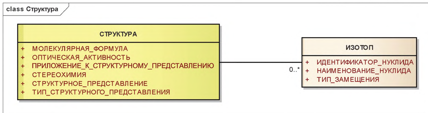
Рисунок 5 — Информационная модель описания структуры и изотопа
