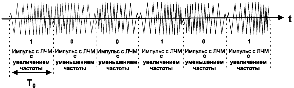
Рисунок 10 – Модулированная двоичная последовательность двухточечной ортогональной ЛЧМ
