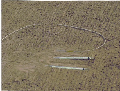
Рисунок 9.2 – Установка датчика температуры подстиляющей поверхности
