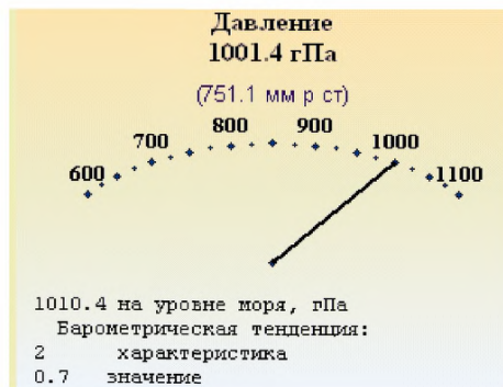
Рисунок 6.2 – Отображение данных о давлении в главном окне АРМ – метеоролога АМК (для версии ПО 1.5.2.1)
