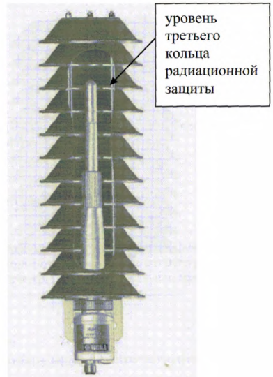
Рисунок 8.4 – Правильное расположение датчика температуры и влажности внутри радиационной защиты
