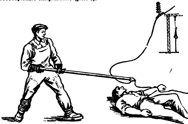
Р и с. 6. Освобождение пострадавшего от тока в установках свыше 1000 В отбрасыванием провода изолирующей штангой
