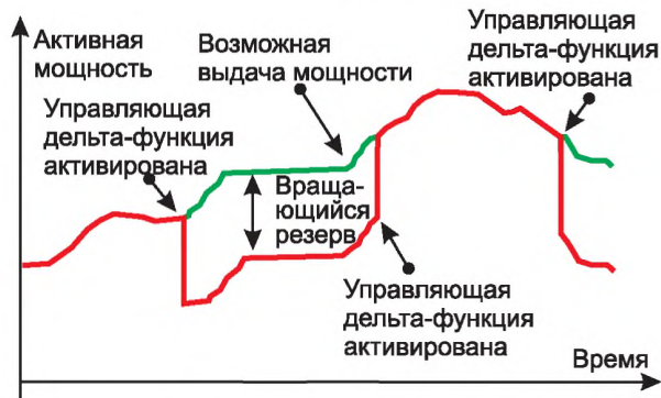
Рисунок В.4 – Схематическое изображение управляющей дельта-функции мощности
