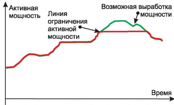
Рисунок В.2 – Схематическое изображение функции управления ограничением активной мощности
