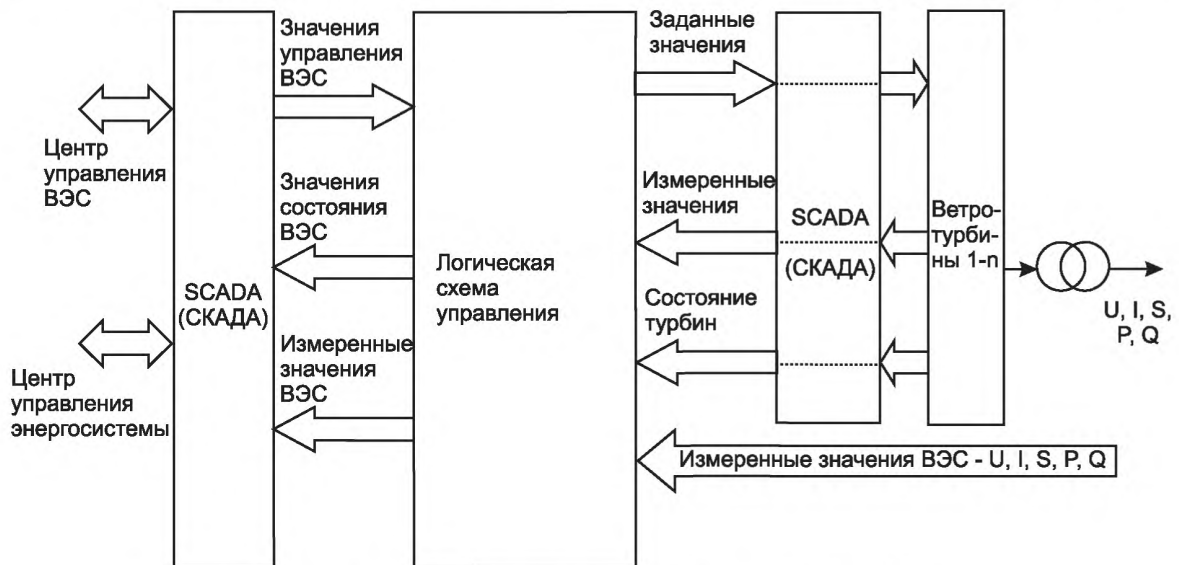
Рисунок В.1 – Концептуальная структура функций управления ВЭС
