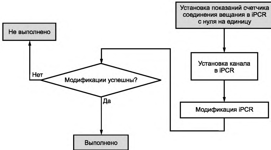
Рисунок 22 — Установка соединения входа в вещание
