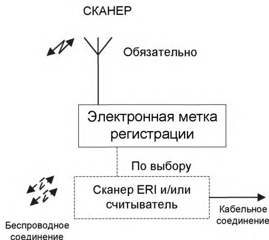
Рисунок 6 – Пример архитектуры ERT
