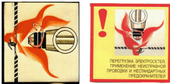
Неисправный предохранитель с «жучком»
