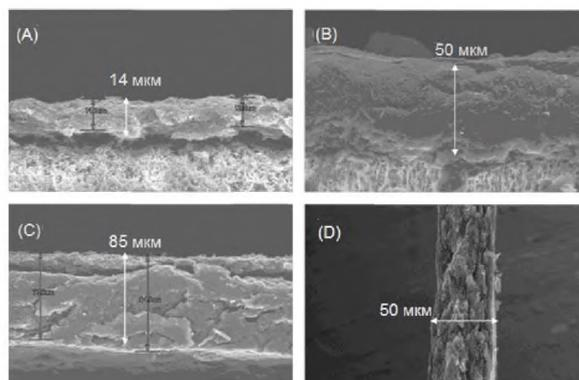
Изображения УНТ-лент, изготовленных с использованием:
